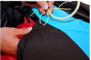
Chiudere il lembo grande in plastica nera usando il cordino e bloccare l'elastico usando il pin della maniglia più lungo, facendolo passare prima nel foro appena sotto all'inserimento maniglia poi nell'elastico e per ultimo nel foro posto dopo l'elastico. Alla fine togliere il cordino sottile.
